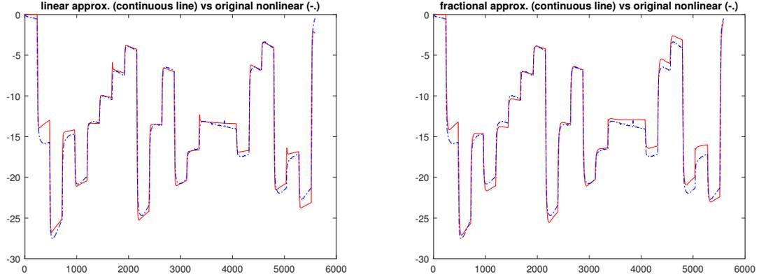
Figura 1: Confronto tra approssimazione frazionaria e ordinaria sulla cella Peltier. A sinistra, l'identificazione ordinaria; a destra quella frazionaria. L'approssimazione è mostrata in rosso, i dati sperimentali in blu. Come si vede, i profili degli output sono molto simili.
